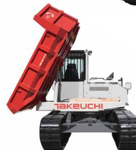
180度回転のダンプ式荷台
