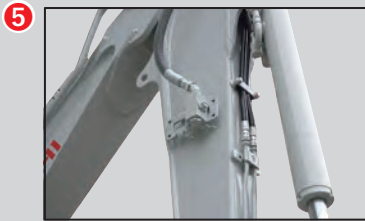
サービス配管
