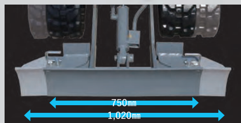
【クローラー幅切替機構】 750 ↔ 1,020mm
