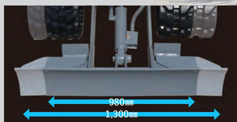
【クローラー幅切替機構】 980 ↔ 1,300mm
